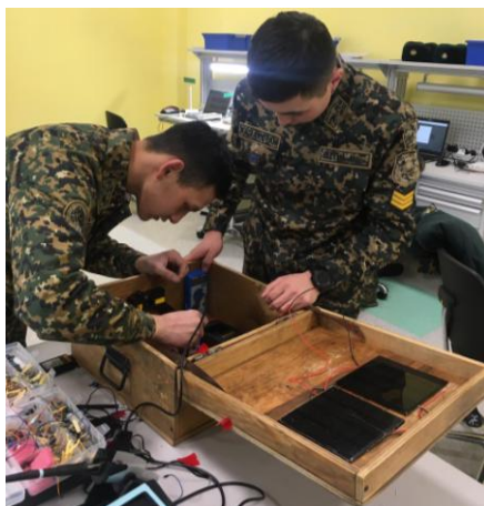
Рис. 11. Монтаж элементов в корпус зарядной станции 2.
