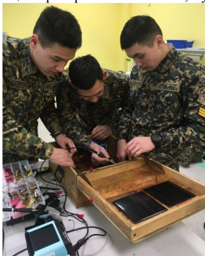
Рис. 10. Монтаж элементов в корпус зарядной станции 1
