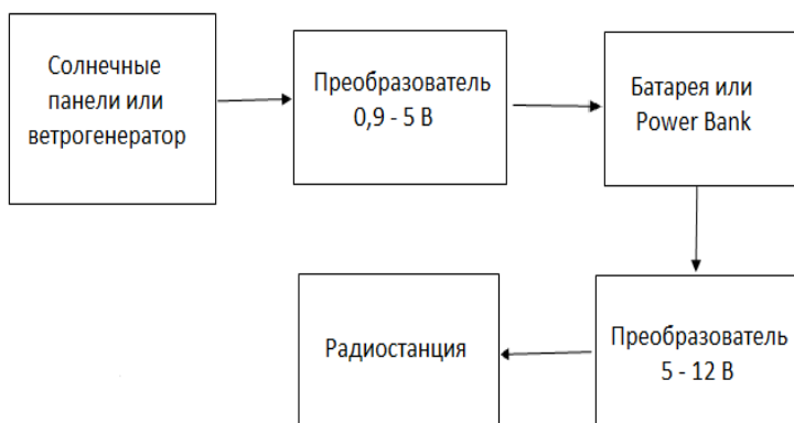
Рис. 1. Структурная схема зарядного устройства
