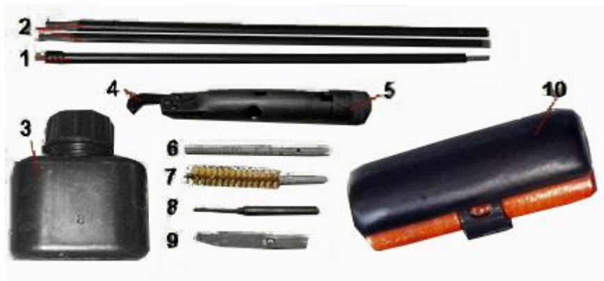
1 – шомпол; 2 – удлинитель шомпола; 3 – масленка; 4 – корпус пенала; 5 – крышка пенала; 6 – протирка; 7 – ерш; 8 – выколотка; 9 – отвертка; 10 – щетка.
