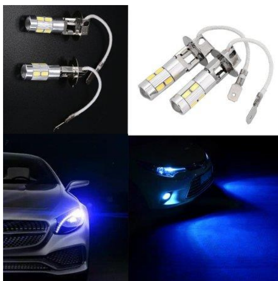
Рисунок 3. Лампы синего свечения для дневных ходовых огней и противотуманных фар
