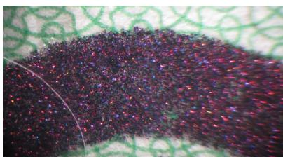
Рис. 91. Увеличенное изображение части элемента, нанесенного цветотпеременной краской на подлинную акцизную марку
