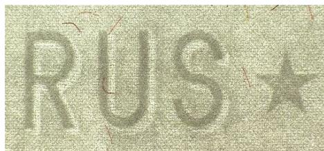
Рис. 19. Увеличенное изображение фрагмента двухтоновых водяных знаков, полученных в проходящем свете
