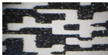
Рис. 86. Увеличенное изображение части штрихового кода, нанесенного способом термографии
