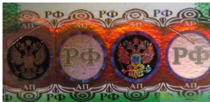
*Рис. 93. Увеличенное изображение голограммической фольги с деметаллизированным узором подлинной акцизной марки*
