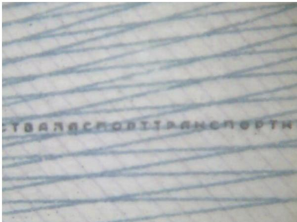
Рис. 42. Увеличенный фрагмент изображения микротекста в ПТС, выполненный способом надпечатки
