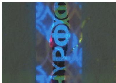
Рис. 52. Увеличенное изображение фрагмента защитной нити на лицевой стороне акцизной марки, люминесцирующей под воздействием УФ-лучей
