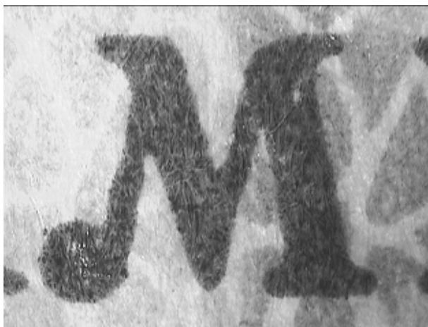
Рис. 39. Увеличенный фрагмент бланка водительского удостоверения, изготовленного способом плоской офсетной печати
