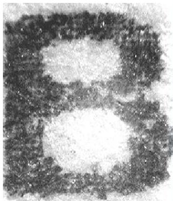
*Рис. 4. Увеличенное изображение буквы, выполненной с помощью формы трафаретной печати*
