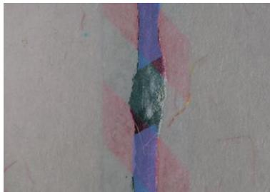
Рис. 51. Увеличенное изображение фрагмента защитной нити на лицевой стороне акцизной марки при осмотре через поляризационный светофильтр
