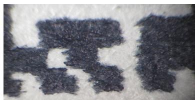
Рис. 85. Увеличенное изображение части штрихового кода, нанесенного способом струйной печати
