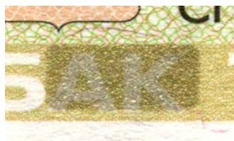
Рис. 78. Увеличенный фрагмент специальной марки, выполненной способом трафаретной печати
