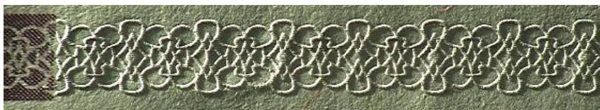
Рис. 25. Увеличенное изображение фрагмента бордюра, выполненного способом металлографской печати с переходом в бескрасочное тиснение в свидетельстве о регистрации транспортного средства образца 2006 г.
