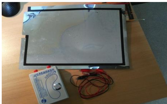
Рис 13. Прибор для изъятия пылевых следов «Следокоп»
