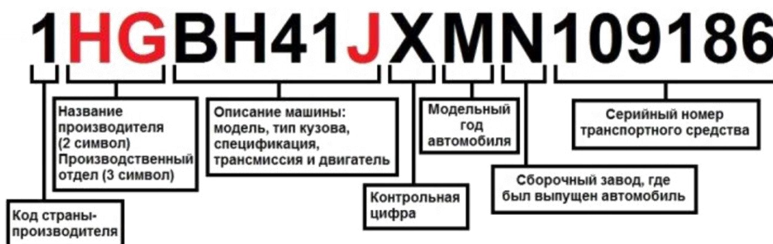
Рисунок 1 – Расшифровка VIN CODE автомобиля
