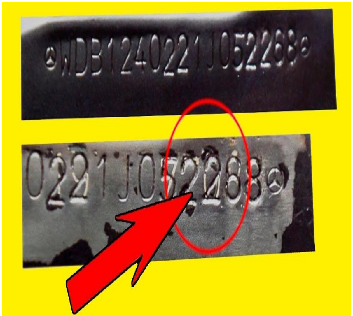
Рисунок В.2 – Поддельный идентификационный номерной знак (VIN CODE)
